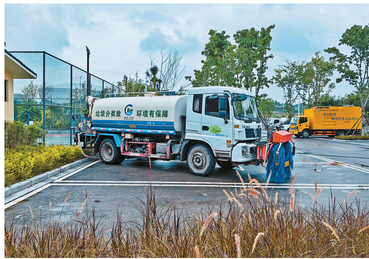
洒水车灌注再生水
